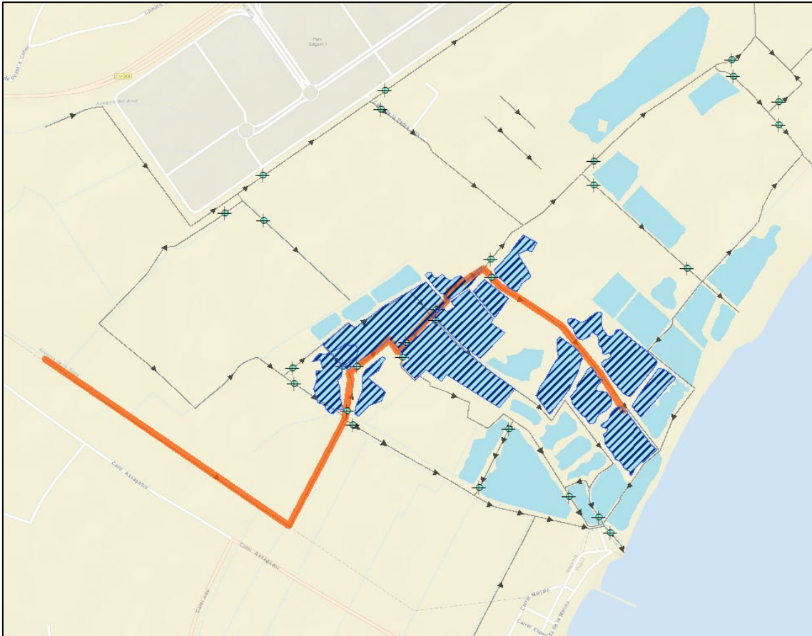
Figura 180. Alternativa 3. En naranja el recorrido propuesto y en azul rayado las lagunas a las que podrían realizarse aportes de agua
